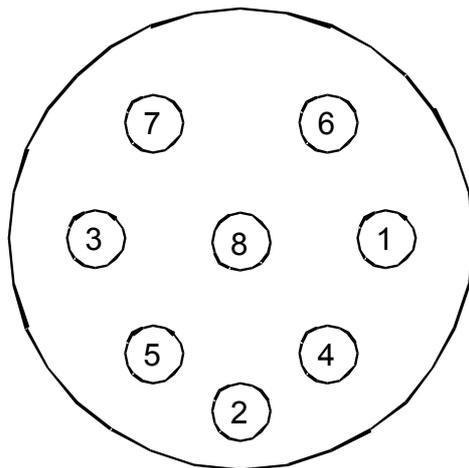
Mini Amp GizmoのAmplifier端子には、Female DIN-8のジャックが採用されています。上図は、Mini Amp Gizmoのファンクションスイッチの番号と、スイッチがOnにされた際に回路がOnになる(グランドにショートする)pinの配列を表しています。例えば、ファンクションスイッチ1がOnになると上図のpin1がグランドに接続されます。
